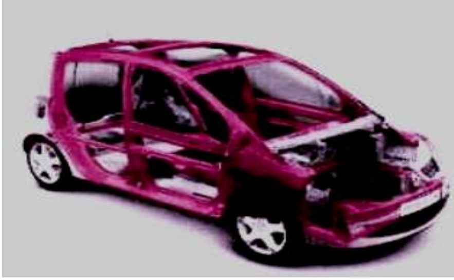
Resim 1.8: Darbelere karşı güçlendirilmiş birleşik şasi
