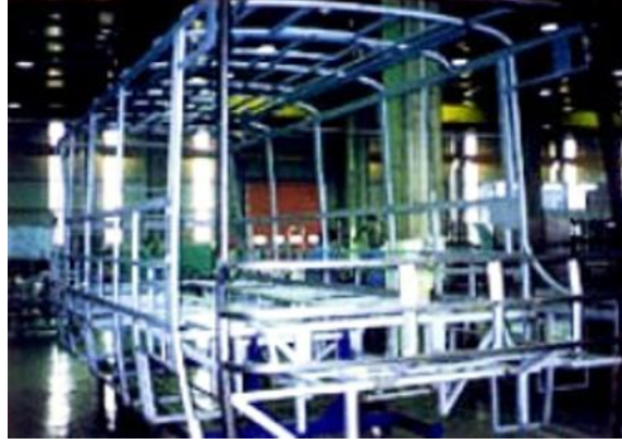
Resim 3.4: Alüminyum uzay kafes şasi
